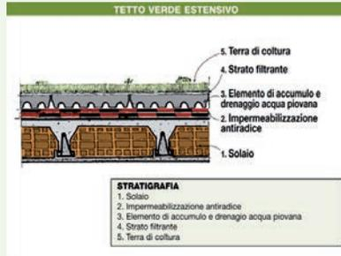
I primi non sono fruibili direttamente dalle persone, non richiedono manutenzioni particolari, lo strato di terreno necessario per la crescita delle piante è ridotto al minimo (intorno ai 10 cm) e impiegano piante erbacee di altezza limitata. Possono essere realizzati in molti edifici in quanto il peso di tutta la struttura difficilmente supera i 100 kg/m<sup>2</sup>.
